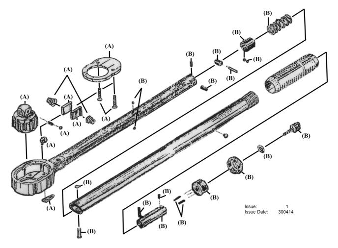
**ITEM PART NO DESCRIPTION** Α AK623.RK REPAIR KIT В AK623.RB REPAIR BAG
